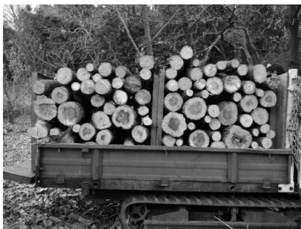
写真-6 不整地運搬車へ積み込み
