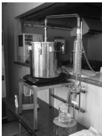
写真3 アロマ蒸留器
