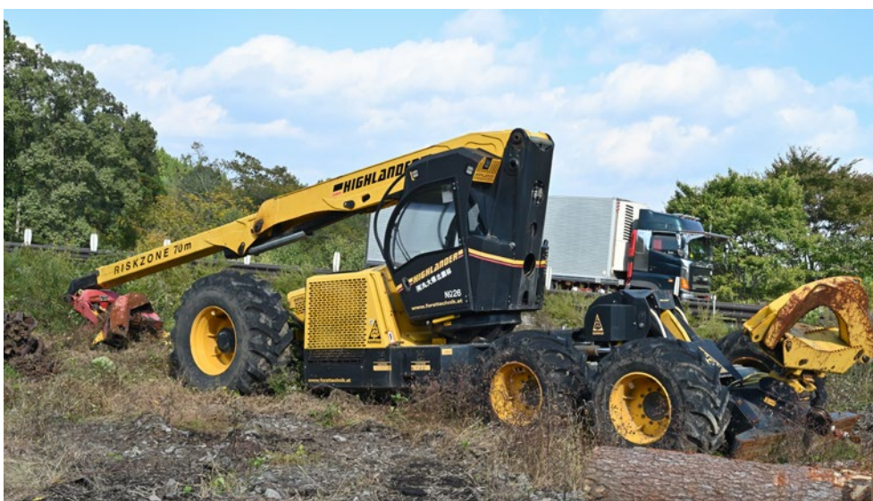
オーストリアのコンラート社製ハーベスタ、ハイランダー。皆伐を年間120ha行っていることから、高性能林業機械も多数保有しています
