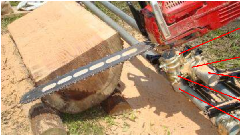
ガイドバー面の垂直方向の角度が可変である構成（移動台はパイプの上部）
