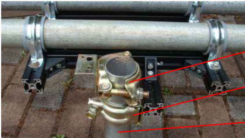
図 7 チェインソー支持機構（移動台はパイプの下部）
