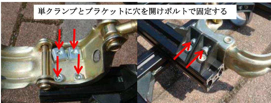
図 8 単クランプとアルミフレームの結合
