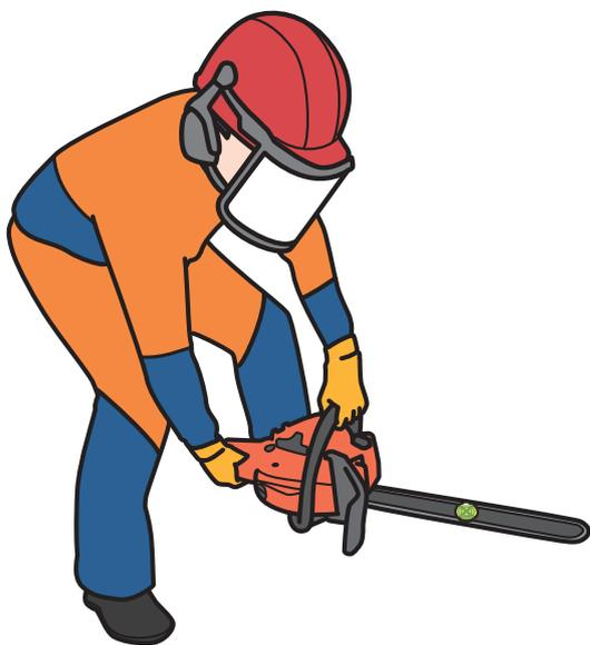
水平感覚の補正。ガイドバーの上に水準器などを置き、自分の感覚と実際の水平を確認します。このほか、目標までの距離が感覚通りか、メジャーで実測すれば距離感覚の補正もできます
