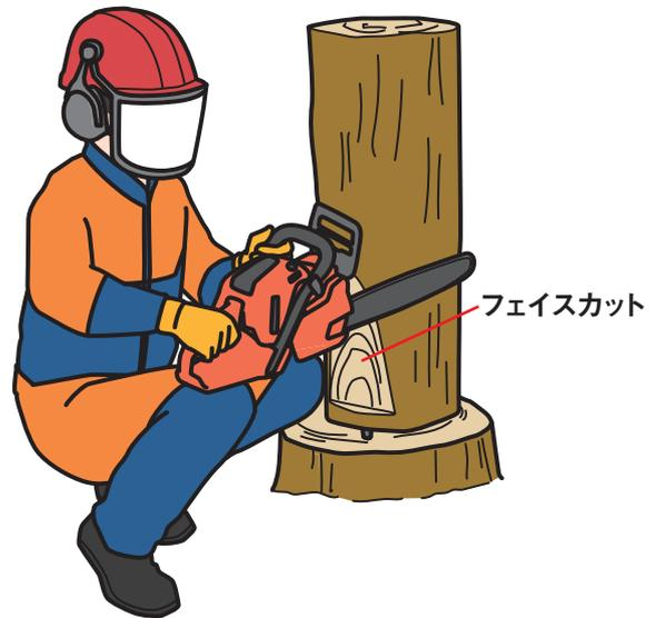
ガンマークを使い、伐倒方向を意識しながら、フェイスカットをして平らな面を作ります
