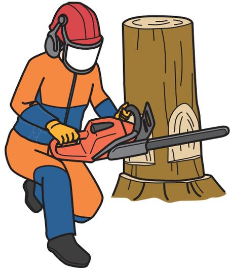
斜め切りを先に切る場合、斜め切りの切り込み時に伐倒方向が決まります
