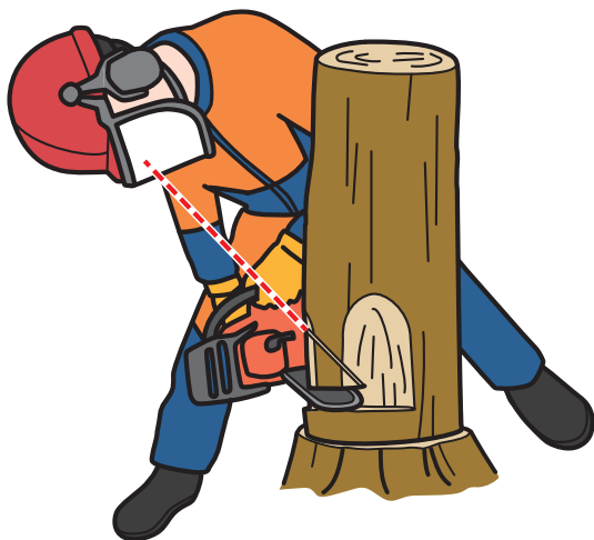
斜め切りの鋸道をのぞき込んで、刃が見えた時が切り終わりのタイミングです
